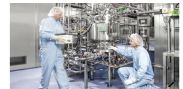
Im Bioreaktor PCF67 stellen tierische Zellen den Gerinnungsfaktor VIII her. Bild: © CSL-Behring
