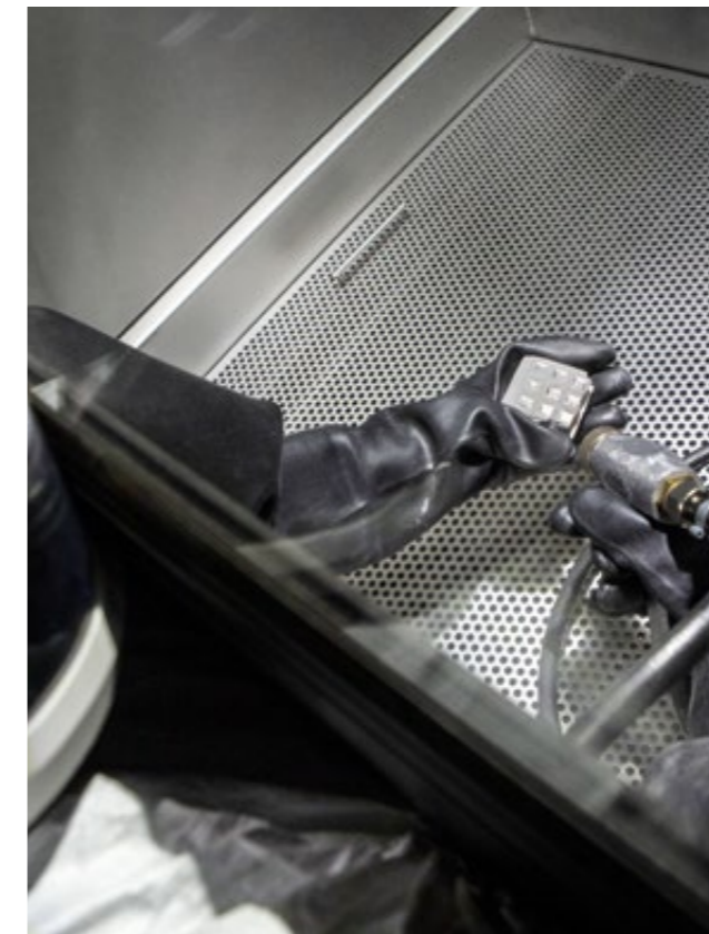
Der 3D-Drucker baut Werkstücke Schicht für Schicht aus pulverisiertem Metall auf. Anschließend muss das nicht verschmolzene Pulver entfernt werden.
