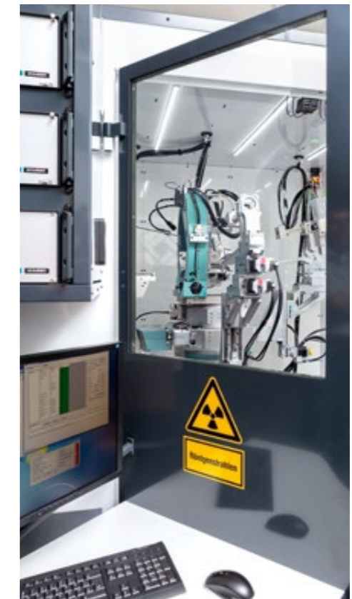
Rasterelektronenmikroskop und Röntgendiffraktometer durchleuchten Probekörper und Werkstücke bis ins Detail. Bilder: © Christine Buhl
