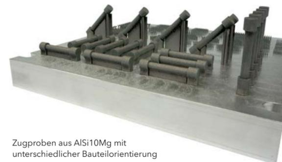
Zugproben aus AlSi10Mg mit unterschiedlicher Bauteilorientierung
