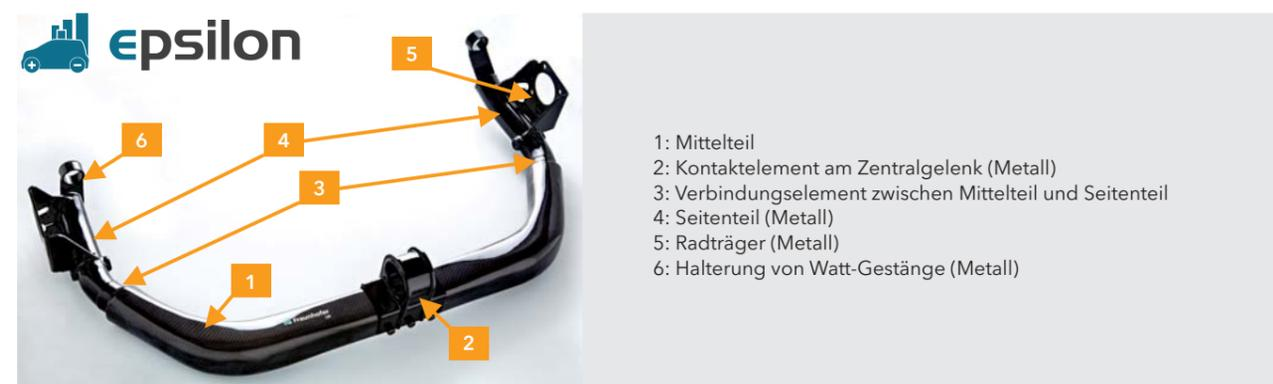
Abbildung 3: Durch die im EU-Projekt „epsilon“ entwickelte Leichtbau-Hybrid-Hinterachse aus Metall und carbonfaserverstärktem Kunststoff (CFK) konnte das Gewicht um rund 35 Prozent reduziert werden. (Bild: Fraunhofer LBF)
