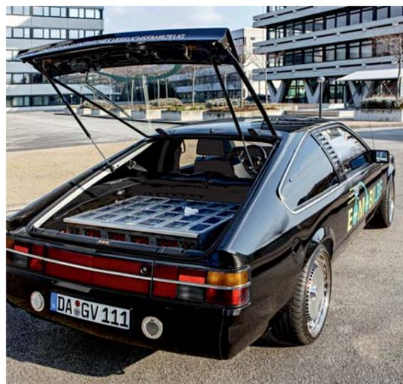
Selbst entwickeltes Konzeptfahrzeug des Fraunhofer LBF mit 10 kWh LFP-Zellen Batterie und integriertem Batterie-Managementsystem
