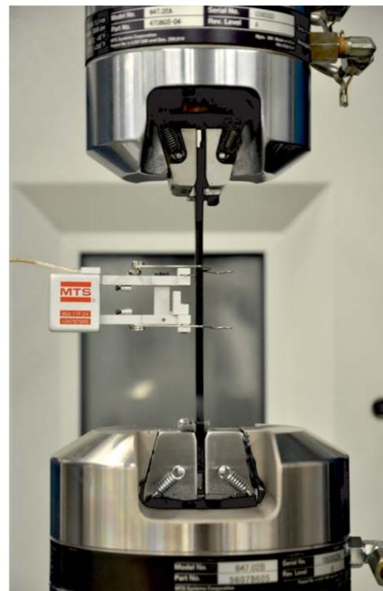
Zyklisch-dynamische Materialprüfung eines kurzfaserverstärkten Kunststoffs
