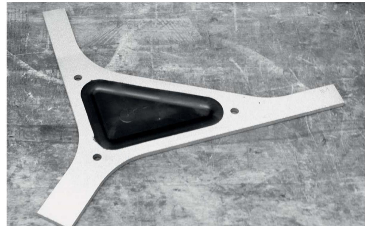
Hybridprobekörper zur Dichtigkeitsuntersuchung
