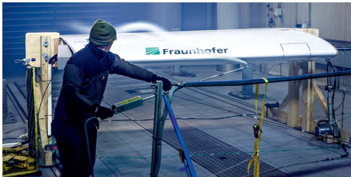
EU JTI CleanSky Flügeldemonstrator mit einer formvariablen Vorderkante im Windkanal
