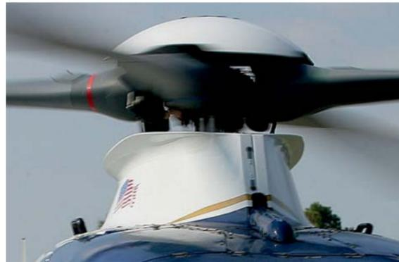
Abbildung 5: Leichtbau durch Funktionsintegration - Lager- und gelenkloser Rotor des Airbus Hubschraubers H135 (vormals EC135, unten) im Vergleich zum voll gelenkigen Rotor. (Bild oben: „Airbus“)
