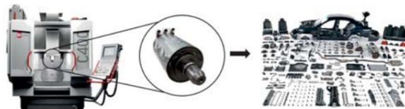
Die Motorspindel ist die Kernkomponente jeder Werkzeugmaschine und ist damit entscheidend für dessen Produktivität.
