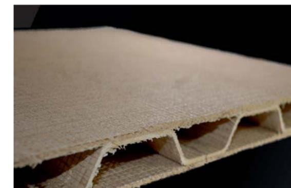
Sandwichstruktur aus flachsfaserverstärktem Papier
