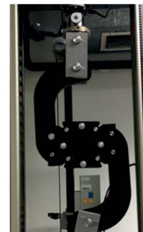
Mit einem Schubrahmen nach DIN SPEC 4885 untersuchten Forscher vom Institut für Kunststofftechnik in Darmstadt die Scherspannung als Funktion der Schiebung für Kohlenstofffaser-Verbunde.
