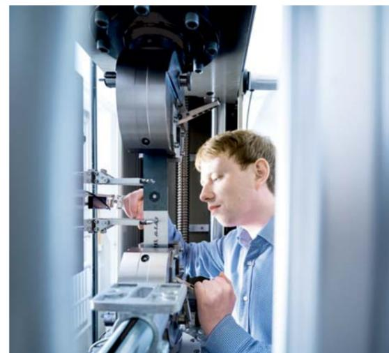
Prüfung der quasistatischen Versagenslasten der Probekörper
