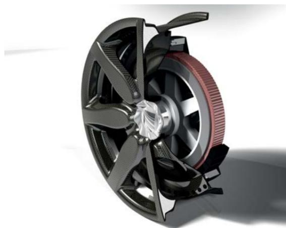
Pkw-Rad mit integriertem Elektromotor
