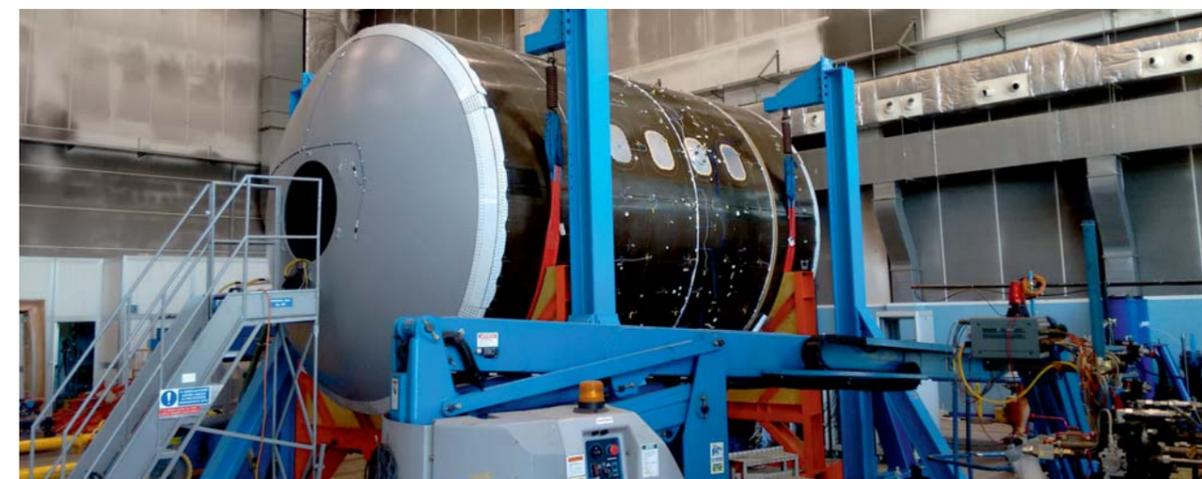
Bodentest im Labor: Ein spezieller Messaufbau erfasst die durch Aufblasen simulierte zyklische Innendruckbelastung an einem Flugzeugrumpf. (Bild: ©Leonardo)
