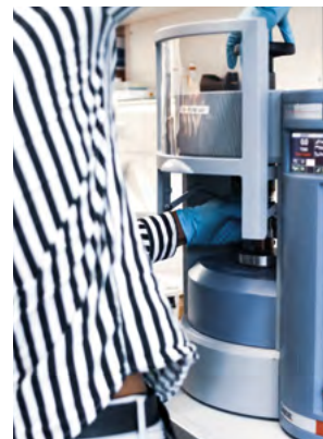
In diesem Gerät werden Feststoffzellen unter Druck zusammengefügt.
