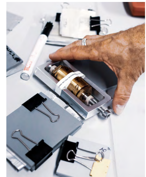
Selbstgebaute Testzellen in unterschiedlichen Formen. Die Zelle in der Hand ist eine Feststoffbatterie in einem Druckgehäuse.
