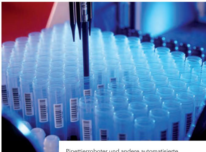
Pipettierroboter und andere automatisierte Verfahren tragen dazu bei, dass Genanalysen immer kostengünstiger werden. (Bild: humatrix)
