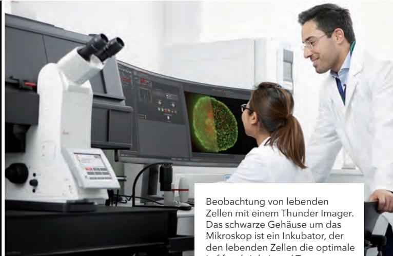
Beobachtung von lebenden Zellen mit einem Thunder Imager. Das schwarze Gehäuse um das Mikroskop ist ein Inkubator, der den lebenden Zellen die optimale Luftfeuchtigkeit und Temperatur bietet. (Bild: Leica Microsystems)
