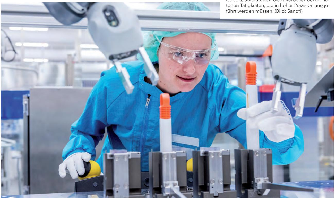
Fertigung von Applikationshilfen bei Sanofi in Frankfurt: Kollaborative Roboter, sogenannte Cobots, unterstützen die Mitarbeiter bei monotonen Tätigkeiten, die in hoher Präzision ausgeführt werden müssen. (Bild: Sanofi)
