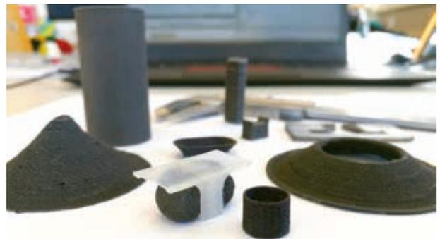
3D-gedruckte Dauermagnete (Quelle: TU Wien)
