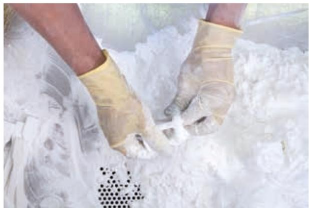
Entnahme von Bauteilen aus dem Bauraum nach dem Lasersintern (Quelle: Kegelmann Technik)
