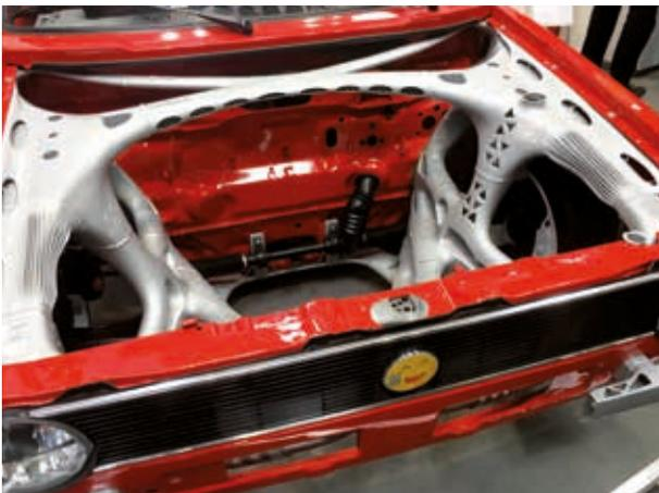
Die Struktur ist besonders leicht und gleichzeitig stabil und verfügt über ein hohes Maß an Funktionsintegration (Foto: Haute Innovation)
