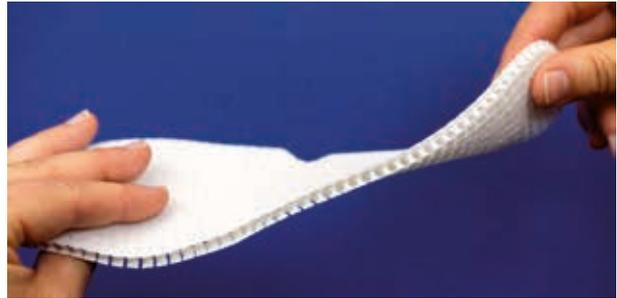
Durch Kombination verschiedener Strukturen in einer Einlegesohle kann ihre lokale Steifigkeit digital eingestellt werden (Quelle: Fraunhofer IWM)
