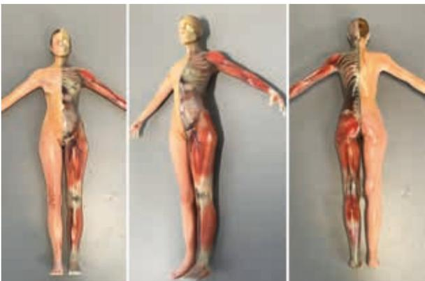
Cuttlefish setzt komplexe Modelle im 3D-Druck mit hochpräziser Farben- und Transluzenz-Wiedergabe um (Quelle: Fraunhofer IGD)
