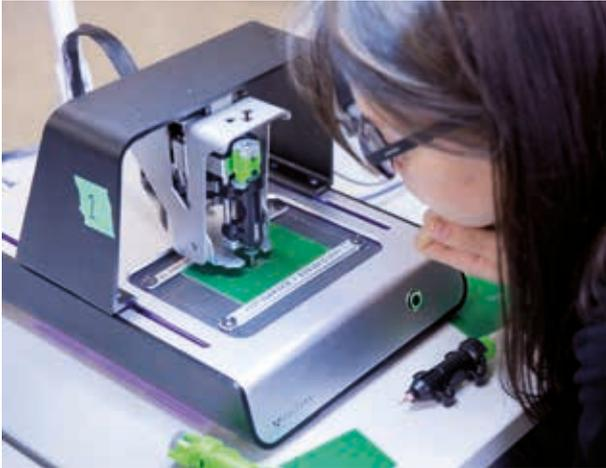
Voltera V One - Leiterplattendrucker für gedruckte Elektronik
