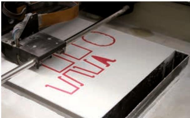
ColorJet-Druck - 3D-Druck-Anlage (Quelle: Materialise)
