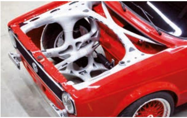
Das 3i-Print-Projekt zeigt an der Vorderwagenstruktur eines alten VW Caddy das volle Potenzial des industriellen 3D-Drucks für die Automobilindustrie (Quelle: csi entwicklungstechnik)
