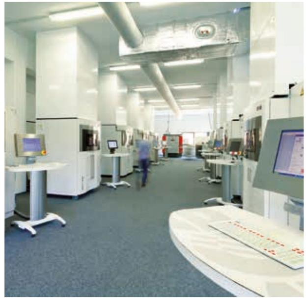
Fertigungshalle mit 39 Lasersinteranlagen und automatisierter Steuerung der Materialkreisläufe (Quelle: FKM Sintertechnik GmbH)
