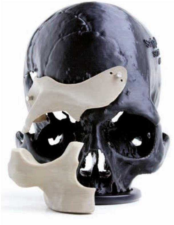
3D-gedrucktes Implantat aus PEEK
