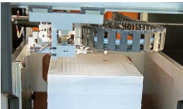
Bauraum einer MCor-Anlage nach dem Schicht-Laminat-Verfahren (Quelle: 3D-Picture, Foto: Dieter Bielert)
