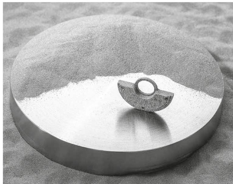
Heraeus entwickelt, liefert und qualifiziert die passenden Metallpulver für die additive Fertigung (Quelle: Heraeus)
