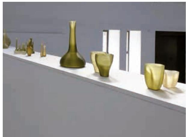
3D-gedruckte Gefäße aus einem algenbasierten Druckfilament
