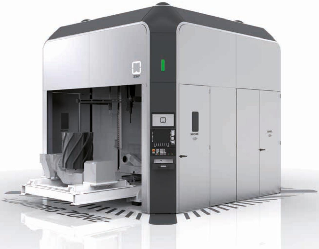
Großanlage zum additiven Draht-Auftragsschweißen
