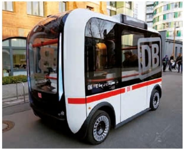
Autonomer Shuttlebus OLLI mit 3D-gedruckten Karosserieelementen (Quelle: Deutsche Bahn)
