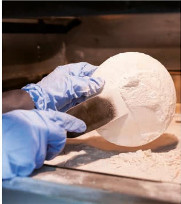
Bauteilentnahme aus dem Pulverbett
