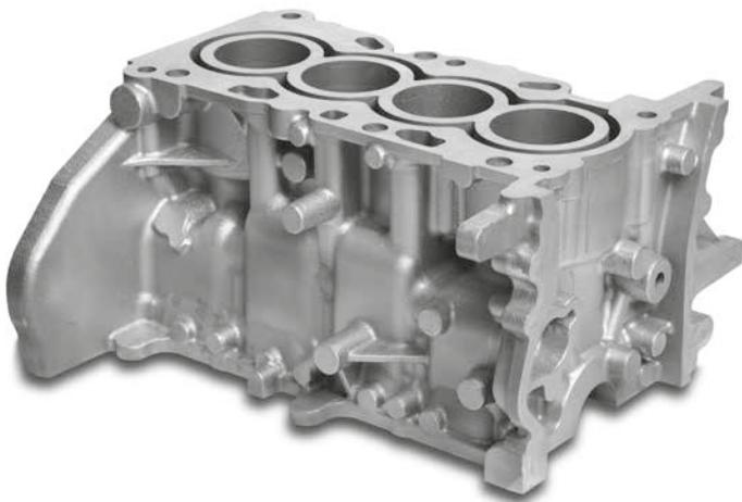
4-Zylinder-Motorblock in AlSi10Mg, additiv erzeugt auf einer der größten verfügbaren Lasersinteranlagen, einer X-Line 2000, mit zwei Lasern à 1.000 Watt, Bauraum: 80 x 40 x 50 Zentimeter (Quelle: FKM Sintertechnik)
