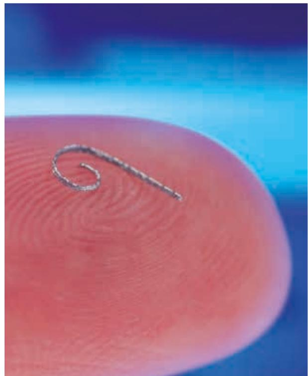
Laser-additiv gefertigter Mikroaktor für Cochlea-Implantate (Quelle: Laser Zentrum Hannover LZH)
