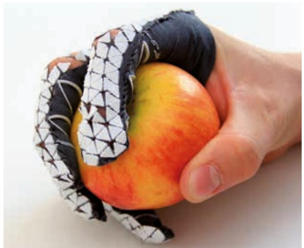
Die menschliche Greifkraft unterstützendes Exoskelett. Es wurde durch 4D-Drucken eines Kunststoffes auf ein vorgespanntes Textil erzeugt (Quelle: ITA Institut für Textiltechnik der RWTH Aachen)
