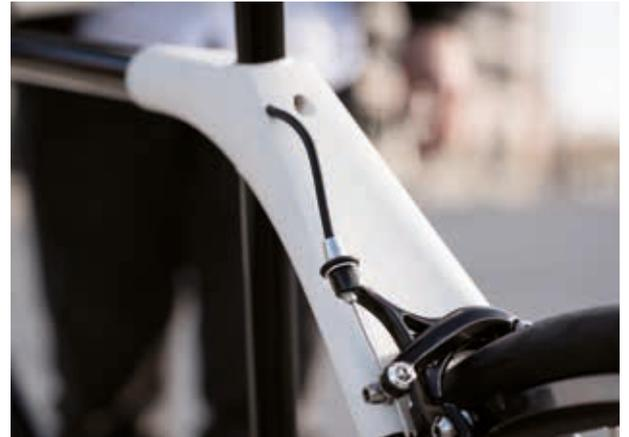
FRAME ONE - 3D-gedruckter Fahrradrahmen
