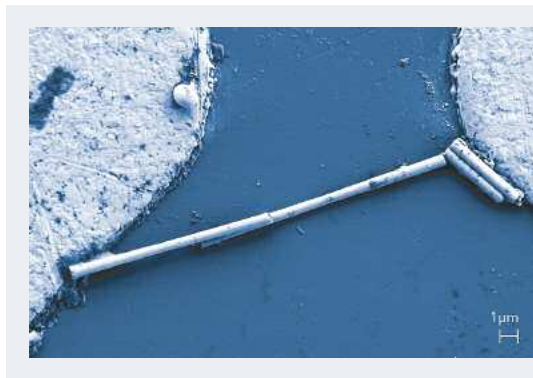
Abbildung 78: Dielektrophoretisch montierte Gold-Drähte (0,6 µm x 14 µm) zwischen Mikroelektroden (Abstand: 25 µm), vgl. [Fiedler 2008].
