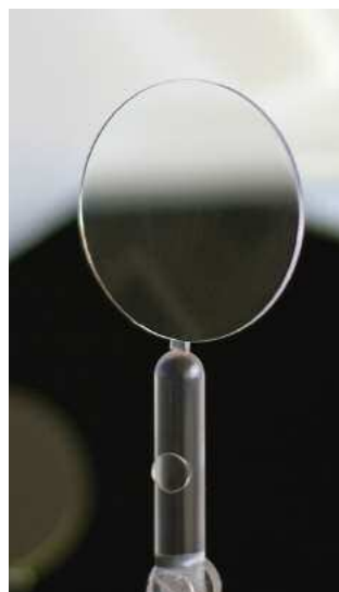
Abbildung 90: Spritzgegossene Linse aus Polycarbonat PC vor nanopartikulär gefüllten Polymerprobekörpern. (Quelle: Technische Universität Darmstadt, Institut EMK/Deutsches Kunststoffinstitut, Abt. Technologie)
