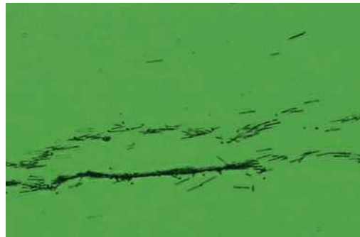
Abbildung 79: In Knoten eines Ultraschallfeldes zu Ketten konzentrierte Gold-Nanodrähte mit 14 µm Länge, vgl. [Fiedler 2008].
