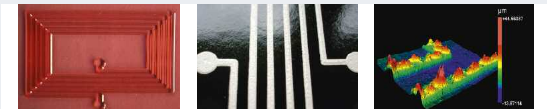
Abbildung 87: Demonstratoren und Messergebnisse für das Projektziel des MerckLab, bis 2011 einen vollständig gedruckten RFID-Demonstrator zu erstellen. (Quelle: Kursawe, M.: Nanotechnologie: Project „Printed Electronics“: Jahrestagung des Mikrosystemtechnik Netzwerks Rhein-Main e.V. 2007. IHK Frankfurt.)
