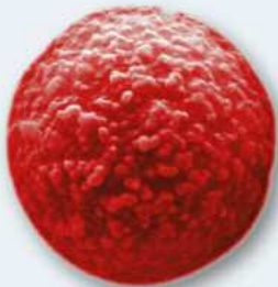
REM-Aufnahme der Oberfläche eines ungünstig gewachsenen Partikels.
