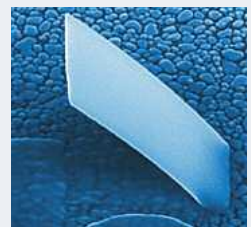
Freistehende MEMS-Komponente (mechanische Blattfeder), hergestellt mit EBID.
