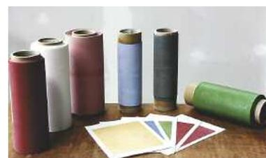
CC-Flex keramische Folien werden durch nanotechnologische Beschichtungsverfahren auf dünnen, flexiblen Trägersubstraten hergestellt (links) und können mit einer Vielzahl von Farbvarianten und Oberflächeneigenschaften ausgestattet werden. (Quelle: Evonik)
