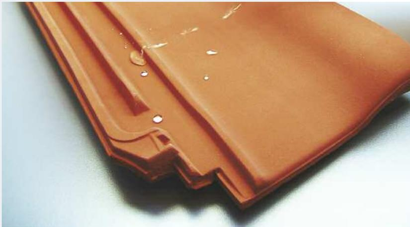
Selbstreinigende Dachziegel durch superhydrophobe Beschichtungen (Quelle: Flad & Flad Communications)
