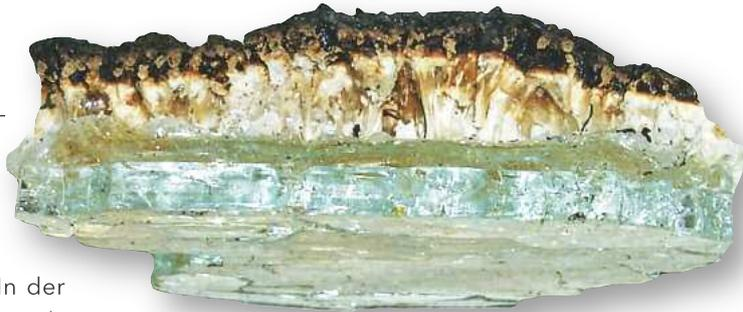
Brandschutzgele auf Basis modifizierter  $\text{SiO}_2$ -Nanopartikel verbessern die Feuerfestigkeit von Verglasungen deutlich. Im Brandfall bildet sich ein formstabiler Schaum aus (oben), der nicht von der Glasoberfläche abfließt (Quellen: INM, Saarbrücken; Evonik)
