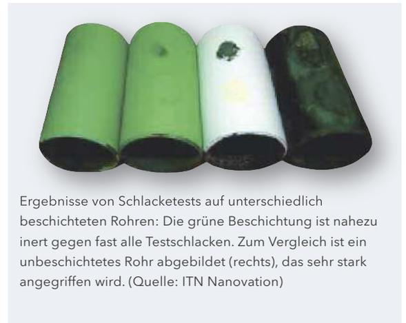
Ergebnisse von Schlacketesten auf unterschiedlich beschichteten Rohren: Die grüne Beschichtung ist nahezu inert gegen fast alle Testschlacken. Zum Vergleich ist ein unbeschichtetes Rohr abgebildet (rechts), das sehr stark angegriffen wird. (Quelle: ITN Nanovation)
