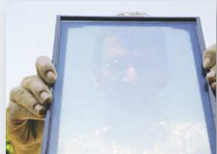
Interferenzschichten bewirken einen winkelahhängigen Transmissionsgrad von Licht (Quelle: INM GmbH)
