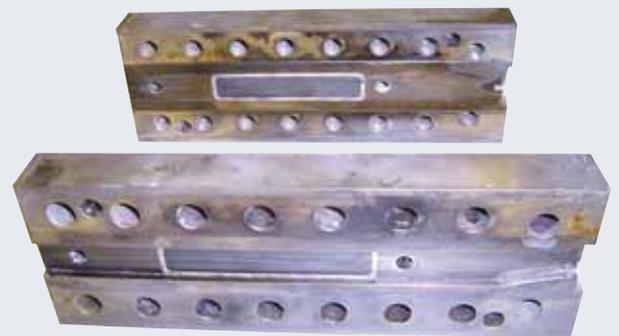
Abb. 6: Messdüse (rechts, aufgeklappt) für Leitfähigkeitsmessungen am Extruder und inline gemessene Leitfähigkeit eines CNT-Polymer-Komposites mit 0,6 Vol.-% MWCNT während der Extrusion und nach den Stopp des Extruders (drei Zyklen bei verschiedenen Schmelzetemperaturen) (verändert aus [8]).
