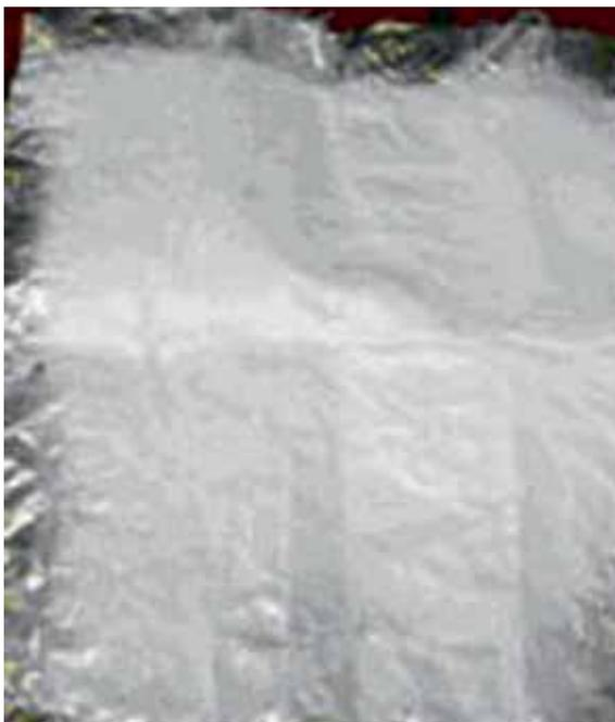
Abb. 1: Elektrogesponnenes Polyvinylalkohol (PVA)-Fasergewebe als dünne Schicht auf Aluminiumfolie mit einem Flächengewicht kleiner  $1 \text{ g/m}^2$  (Foto Uni Marburg).
