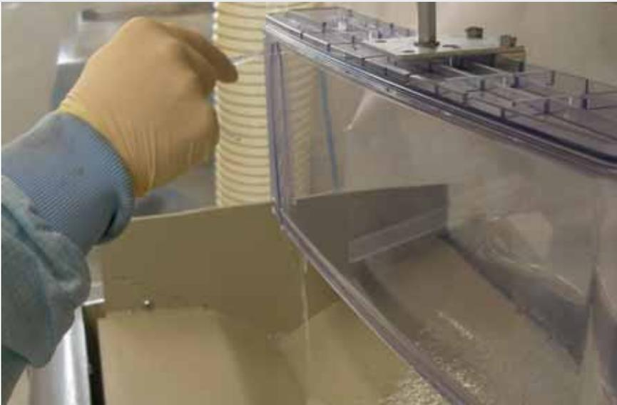
Abb. 4: Flutbeschichten einer Gerätetür aus ABS
