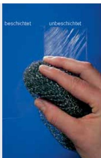
Abb. 3: Abrasionsschutz transparenter Kunststoffe durch UV-härtende  $\text{SiO}_2$ -Nanopartikel haltige Lacke, Stahlwolletests, linke Seite beschichtet (Quelle: Firmenbroschüre Fa. Caparol Industrial Solutions GmbH).
