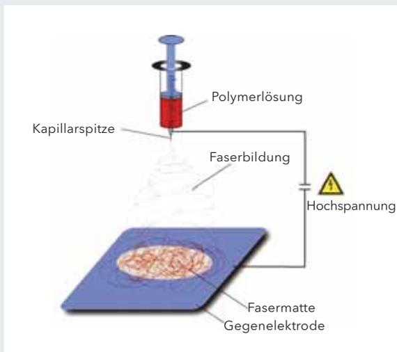
Abb. 2: Schematischer Aufbau des Elektrospinprozesses (Quelle: Uni Marburg).
