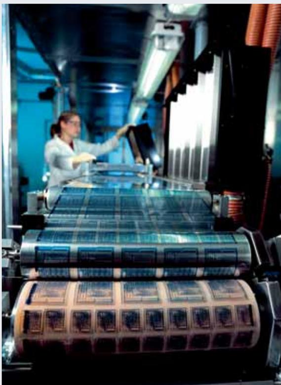
Abb. 15: Rolle-zu-Rolle-Druck zur Produktion von polymerbasierten Bauteilen für die Elektronik (Foto: PolyIC-Pressbild).
