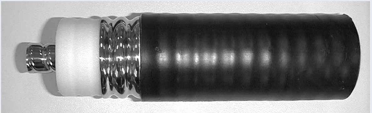
Abb. 2: Coaxial-Kabel mit einer halogenfreien, Nanokomposite basierten äußeren Ummantelung (Foto: Autor).
