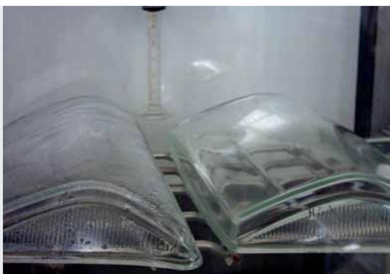
Abb. 4: Antifoggingausrüstung von Polycarbonatabdeckungen für Automobilscheinwerfer, rechte Seite beschichtet mit Hybridpolymer. Die Transparenz bleibt auch bei hohen Luftfeuchten erhalten - Konstantklima  $40\text{ }^{\circ}\text{C}$ , 100 % Feuchte nach DIN 50017 (Quelle: Fa. Genthe X Coatings; Workshop at IQPC - Intelligent Interior Lighting Frankfurt/Main September 27, 2004).
