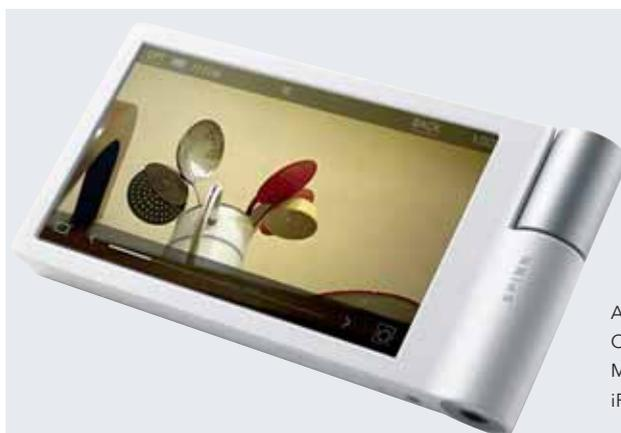
Abb. 1: Aktiv-Matrix OLED-Display eines MP3-Videoplayers (Foto: iRiver, Europe).
