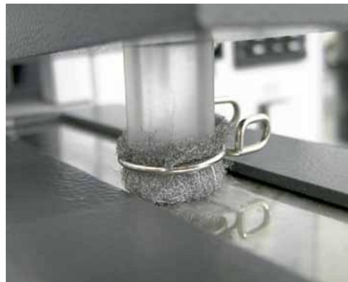
Abb. 2: Kratzbeständigkeit von Kunststoffen - Crockmeterprüfung mit Stahlwolle 000 (Foto: Caparol Farben Lacke Bautenschutz).
