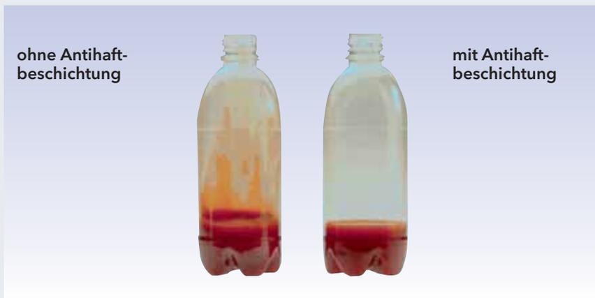
Abb. 5: Einfluss der Plasmaoberflächenbehandlung auf die Entleerbarkeit von PET-Flaschen (Quelle: Fraunhofer IVV/IGB Freising/Stuttgart).
