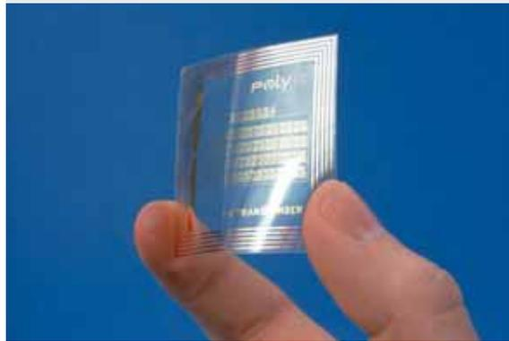
Abb. 17: Radio-Frequency Identification Device (RFID) auf Polymersubstrat (Foto: PolyIC-Pressbild).
