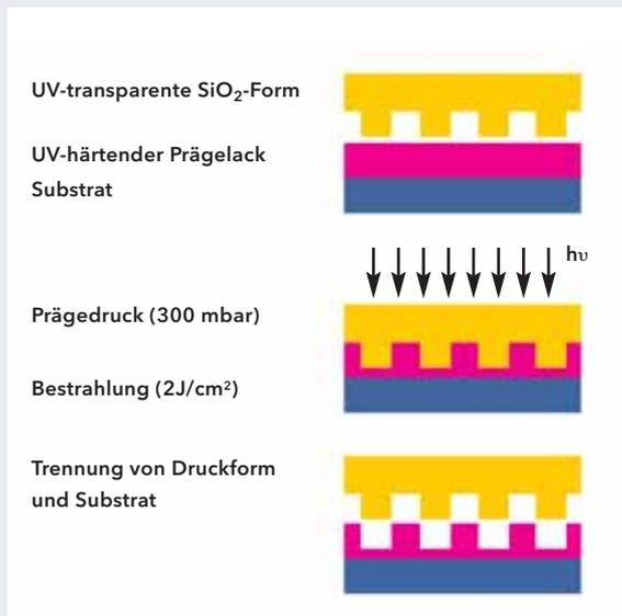
Abb. 3: Schematische Darstellung zur Funktionsweise des UV-Nanoimprint-Verfahrens (Bild: Molecular Imprint).
