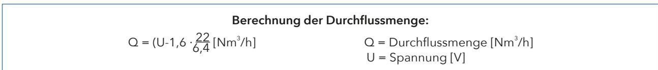
Abbildung 18: Umrechnung der Spannung in die Durchflussmenge
