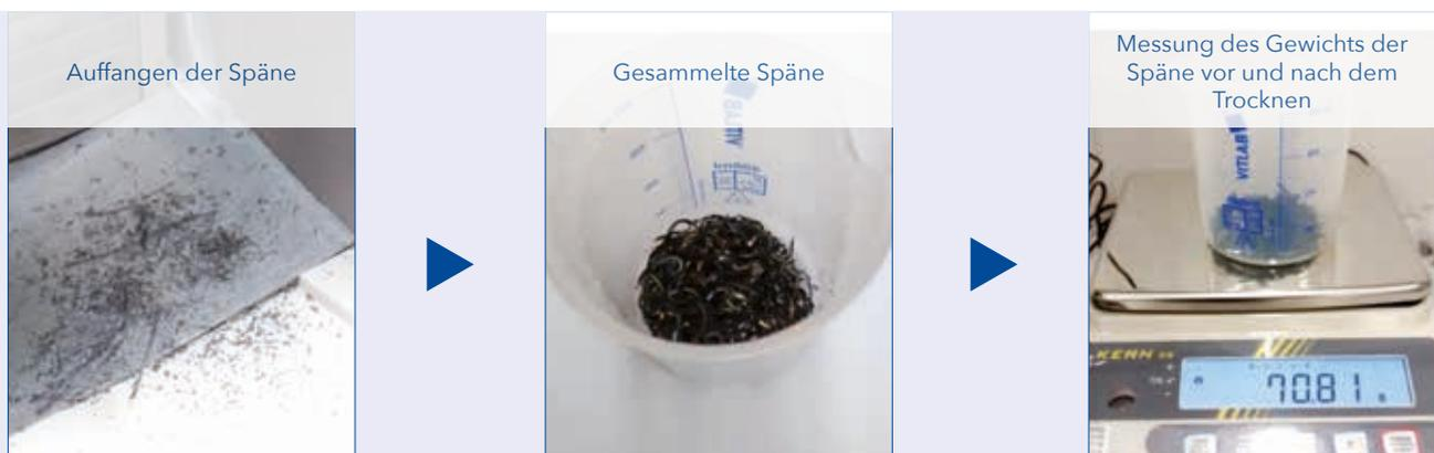
Abbildung 20: Messung des KSS-Austrags
