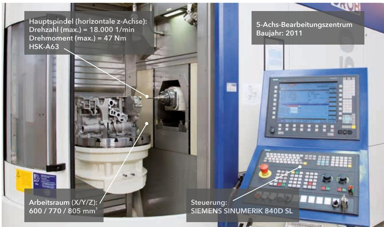
Abbildung 11: Ausgewählte Werkzeugmaschine zur Durchführung der Experimente
