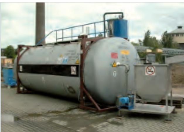
Pilotanlage zur Milchsäurefermentation in Frankfurt am Main
