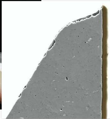
Selbstschärfendes Schneidwerkzeug (Querschnitt) (Quelle: Fraunhofer UMSICHT)
