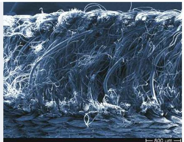
Elektronenmikroskop-Foto des Prototyps eines Textils inspiriert durch die Ölbienen
