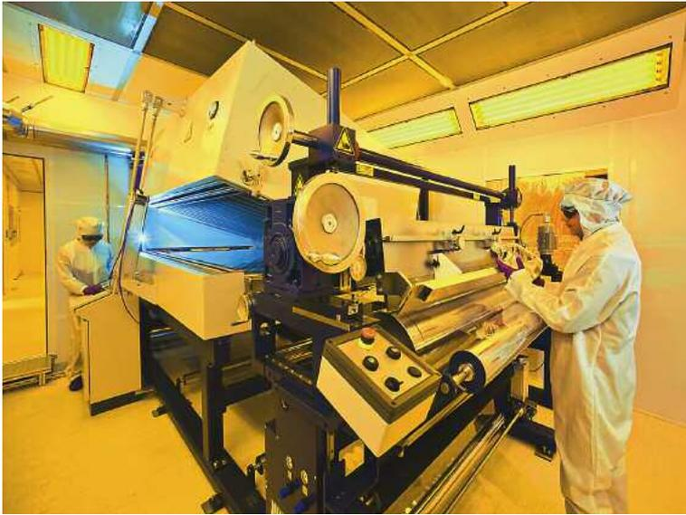
Beschichtungsanlage zur Herstellung strukturierter Polymerfolien (Quelle: INM, Foto: Uwe Bellhäuser)
