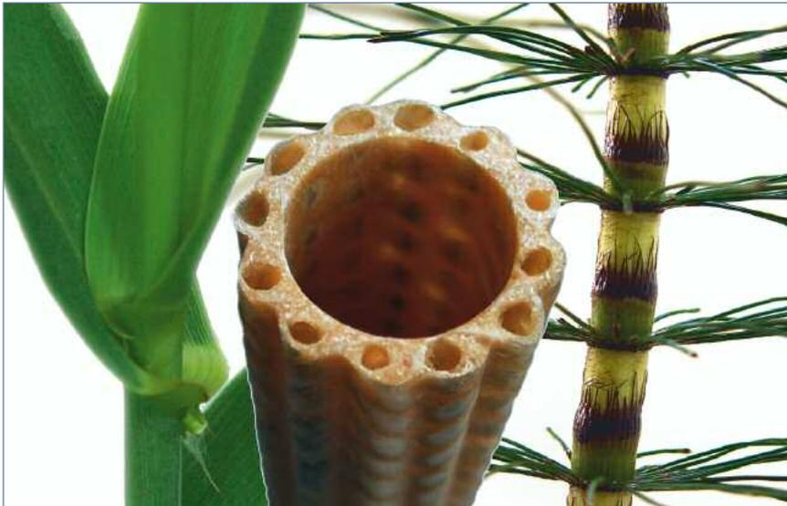
Der technische Pflanzenhalm, ein bionisches strukturoptimiertes Faserverbundmaterial, mit den biologischen Vorbildern Pfahlrohr (links) und Schachtelhalm (rechts).
