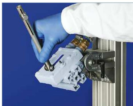
Forschung und Entwicklung im Kontext Anti-Eis-Beschichtungen – Beurteilung der Reifhaftung durch einen Reif-Adhäsions-Test. (Quelle: FhG IFAM)
