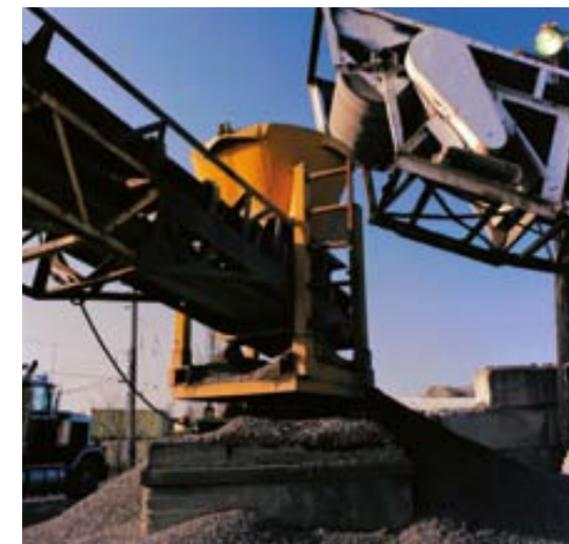
Zuschlagstoffe zur Herstellung von Recycling-Beton werden gemischt.
